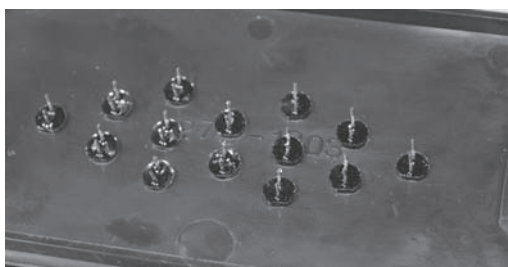
RYСУNEK 10.30. Montaż diod LED w tym samym położeniu
