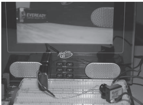
RYСУNEK 10.8. Testowanie kamery z monitorem wideo
